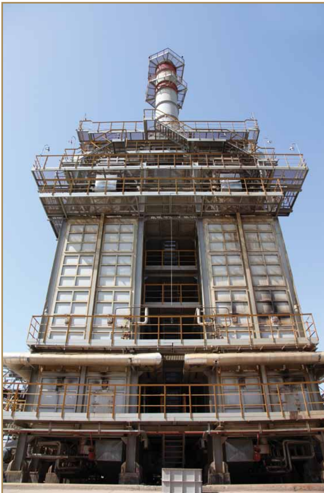
АВТ-3 ЭТ қондырғысындағы жаңа пеш Новая печь на установке АВТ-3 ЭТ New heater at Crude Vacuum Unit
